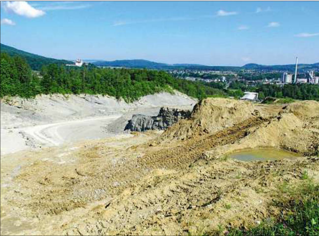
Im Abbaugelände Oberegg wird an verschiedenen Stellen abgebaut, denn die moderne Zementproduktion verlangt nach einer nuancierten Zusammensetzung des Rohmaterials
