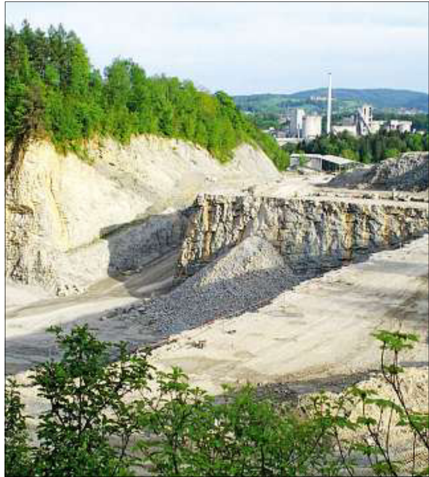
Im Abbaugelände Oberegg wird an verschiedenen Stellen abgebaut, denn die moderne Zementproduktion verlangt nach einer nuancierten Zusammensetzung des Rohmaterials
